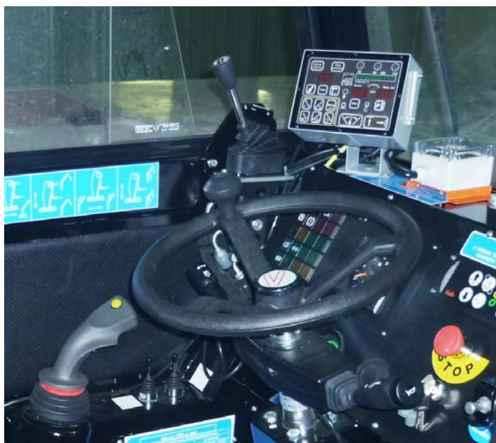
АС-АОГ-01м+ "В" и пример его размещения (кабина крана Valla)
