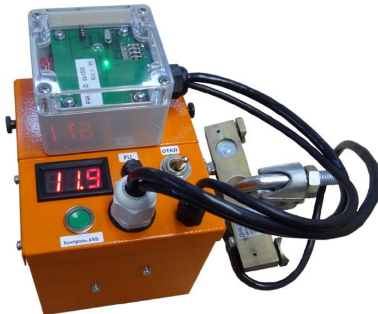
Датчик усилия тросовый беспроводной с чувствительным элементом ДНК
