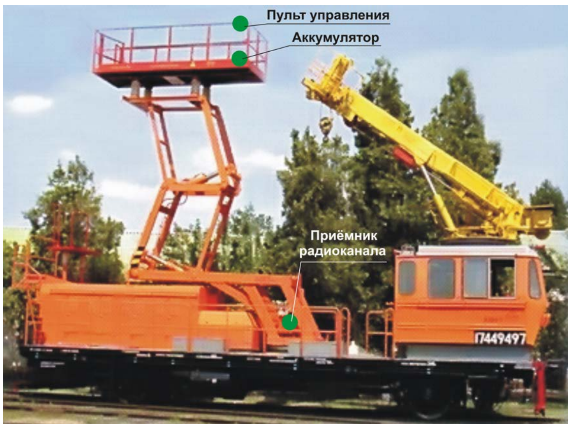
Размещение элементов системы АС-СДУ-01.2 на площадке монтажной
